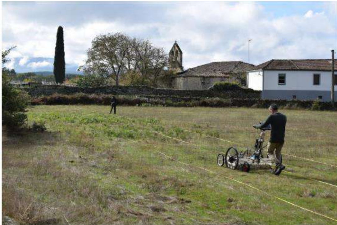
Figura 6. Prospección con xeo-radar no xacemento romano de Proendos (Sober, Lugo).
