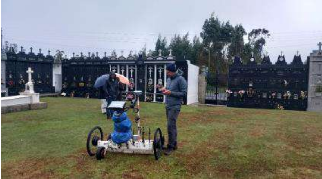
Figura 11. Prospección con georradar IDS RIS FastWave SOT.
