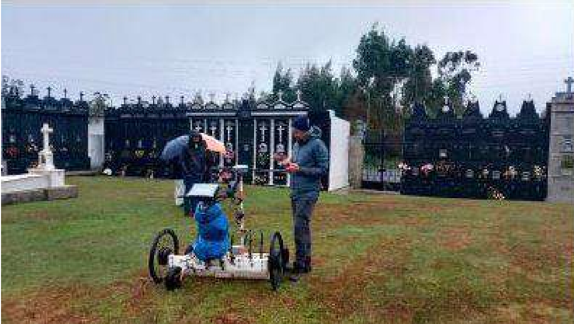
Prospección con xeorrádar IDS RIS FAStWave SOT no cemiterio de Santiago de A Capela
